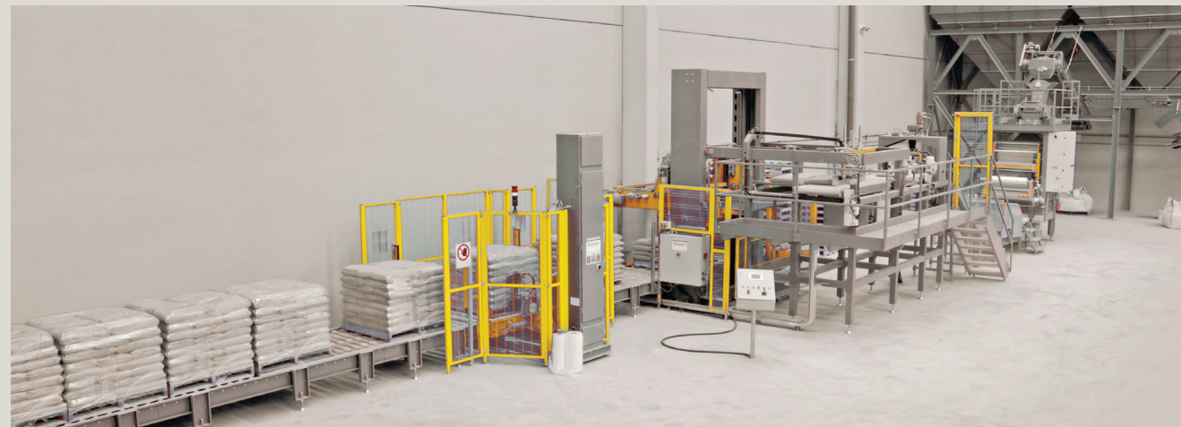
Packaging line for building materials. Capacity: 1,500 bags/hour. Línea completa de ensacado de productos para la construcción a 1.500 sacos/hora
