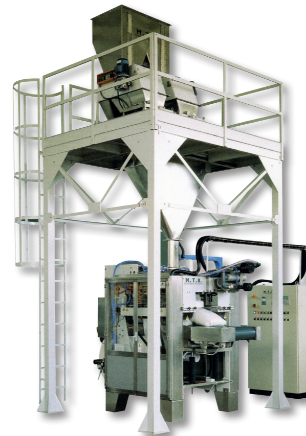
Ensacadoras FFS de Bobina Tubular • Hasta 1.600 sacos/hora. FFS Tube Reel Bagging Machines • Up to 1.600 bags/hour.
